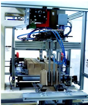
სურათი 34 ფირმა „Siem“-ის მიერ წარმოებული, მუყაოს კოლოფებში ბოთლების ჩასაწყობი მანქანა
