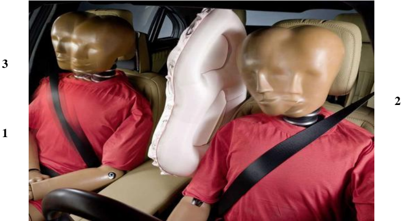
ნახ.12. ფირმა Mercedes-Benz-ის გააქტიურებული გასაბერი ბალიში: 1-გასაბერი ბალიში; 2-მძღოლის მანეკენი; 3-წინ მჯდომი მგზავრის მანეკენი
