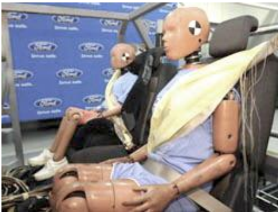
ნახ.7. ფორმა Ford-ის გასაბერი უსაფრთხოების ღვედები: 1-გასაბერი უსაფრთხოების ღვედი; 2-ჩვეულებრივი უსაფრთხოების ღვედი; 3-მანეკენი
