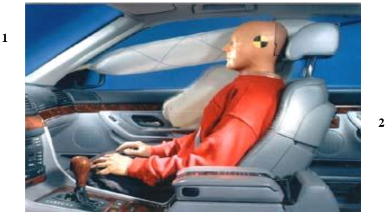
ნახ.11. ფირმა BMW-ს გააქტიურებული მილისებრი ბალიში ITS: 1-მილისებრი ბალიში ITS; 2-მგზავრის მანეკენი
