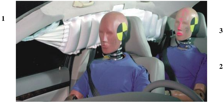
ნახ.10. ფირმა Volvo-ს გააქტიურებული გასაბერი ფარდა IC: 1-გასაბერი ფარდა IC; 2-წინ მჯდომი მგზავრის მანეკენი; 3-უკან მჯდომი მგზავრის მანეკენი
