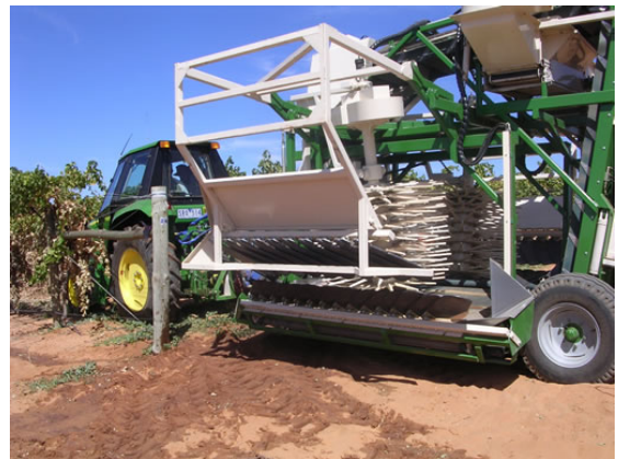
სურათი №2. მოსავლის ასაღები აგრეგატი-რეპული მოწყობილობა ტრაქტორზე
