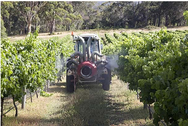
სურათი №5. შესასხურებელი აპარატი-ატომიზერი (ულტრამაღალი წნევით შესხურება)
