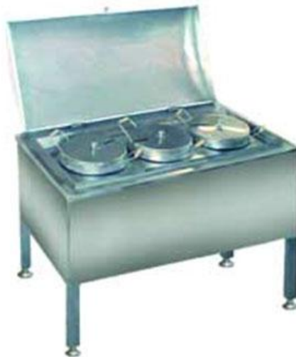
სურათი 6,3,1. დედოს მოსამზადებელი აპარატი
