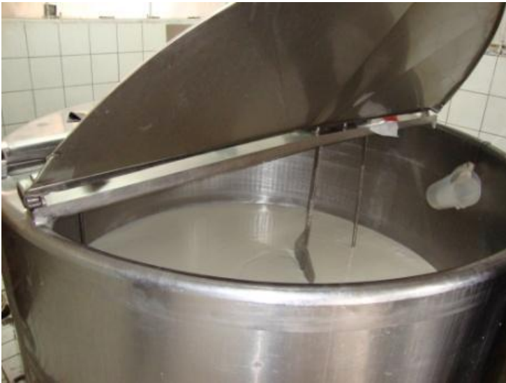
სურათი 2,6,1. რძის გამაცივებელი ავზი სარევით და ავტომატური მართვით
