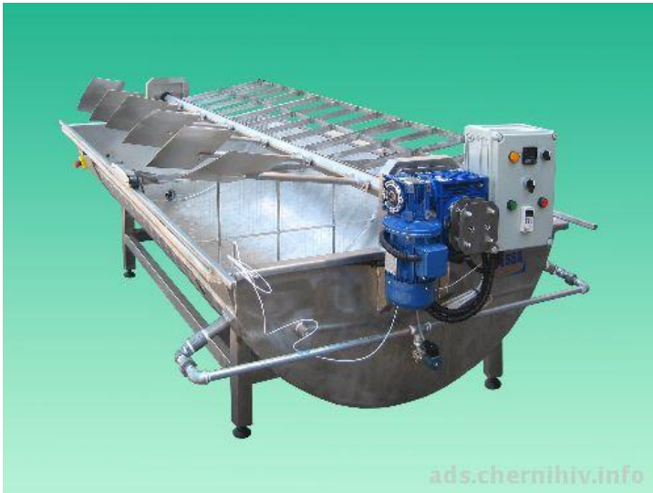
სურათი 6,12,2. ხაჭოს დასამზადებელი დანადგარი
