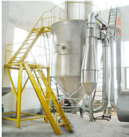
სურათი 9,8,1. მშრალი საღი რძის გაფრქვევის წესით დამზადებისთვის გამოყენებული კომპურა დანადგარი
