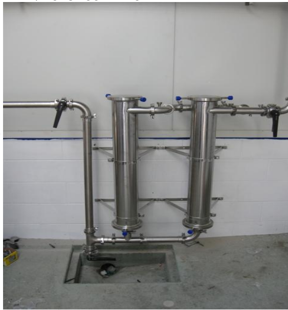
სურ.2.2.1 რძის გაფილტვრა სურ. 2.2.2. რძის ფილტრაცია ((რძეგამტარი)
