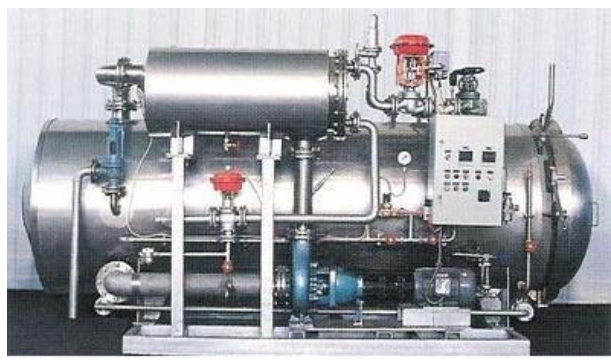
სურ. 5.5.1. ვერტიკალური ორკალათიანი ავტოკლავი ჰორიზონტალური ავტოკლავი
